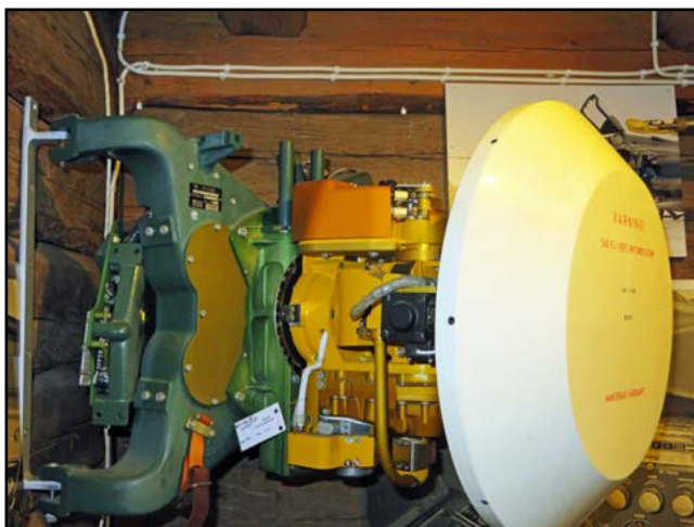
Göran Hawée modifierade flygplanradarn PS-01 och stora delar av vapensystemet på J 35F och J 35J. Bilden visar radarantenn från en PS-01.
