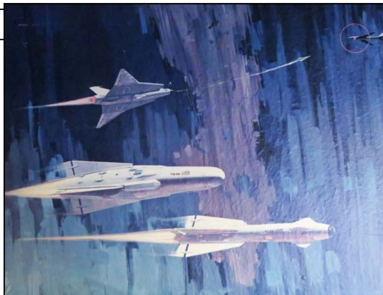
Jaktröbotanfall av en svensk J 35F mot högflygande fientligt bombflygplan. De amerikanskstiltverkade robotarna är av Falcon-typ, RB 27 med radarmålsökare och RB 28 med IR-målsökare.
