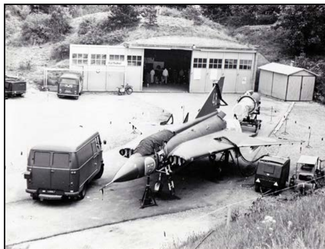
Teknisk personal visade olika tekniska arbeten vid en upphissad J 35A utanför Hangar 91. Här har motorn tagits ur flygplanet och är uppställd bakom flygplanet.
