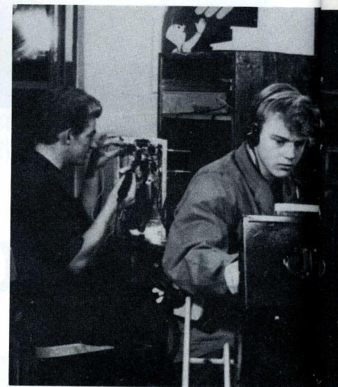
Folke Sundholm med en av telemontörerna. Funktionskontroll pågår av den egenhändigt byggda radiosändaren (Hartleykopplad oscillator) med hjälp av en gammal flygradiomottagare (FR2?).
