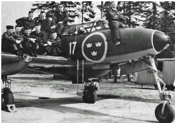
F17 flygplan var A21RB, här med F 17 flygtekniker på vinge och nos. Bokstaven B står för licens-tillverkad motor Goblin 3, svensk beteckning RM1A
