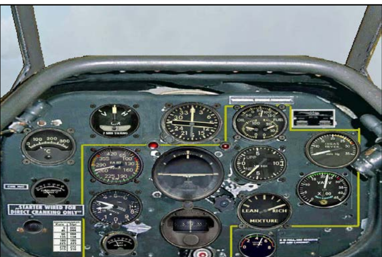
Instrumentpanelen i en SK 16. Bankningsvinkeln är NOLL!
