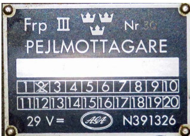
Att komma åt en FRP3 Peljmottagare i luckan under flygplan J 29s buk, för att läsa på märkplåten var förknippat med mycken möda.
